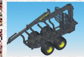
Die Winde wird fix an den Hinterrahmen der Maschine montiert. Wir planen und realisieren die Montage der Winde an Ihren gebrauchten oder neuen PONSSE Forwarder. Verfügbar für Wisent, Elk, Buffalo und Elefant
