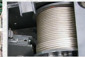
Durch die optimale Seilwicklung können 7 Seilagen auf die Trommel gewickelt werden. Dadurch wird auch die Lebensdauer des Seils maximiert.
